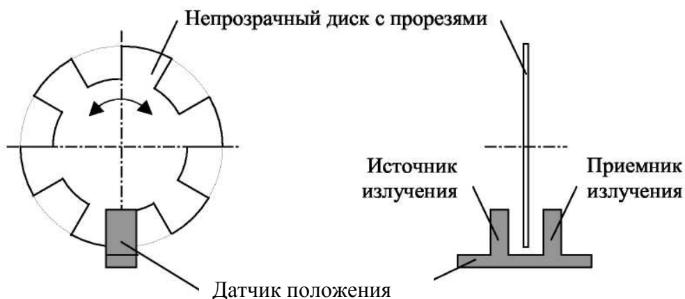
Рисунок 7. Датчик положения мехатронного модуля линейного перемещения
