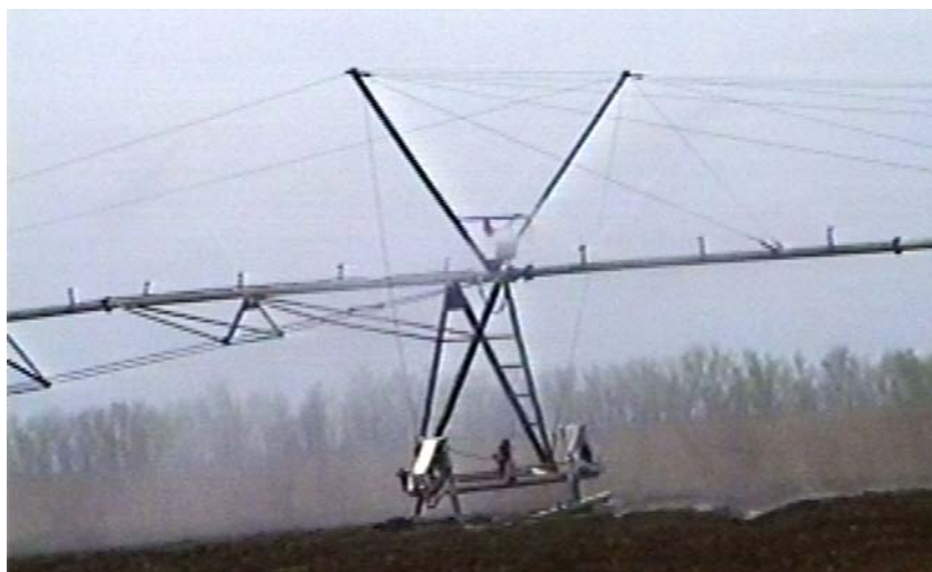
Рисунок 3 — Опытный образец шагающей опоры дождевальной машины
